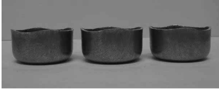
Şekil 5. 2. Prosesle ait tavlı malzemenin derin çekme testi sonrası görüntüsü
