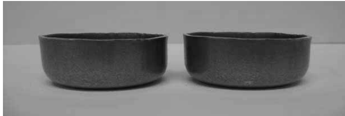
Şekil 6. 4. prosesle ait tavlı malzemenin derin çekme testi sonrası görüntüsü
