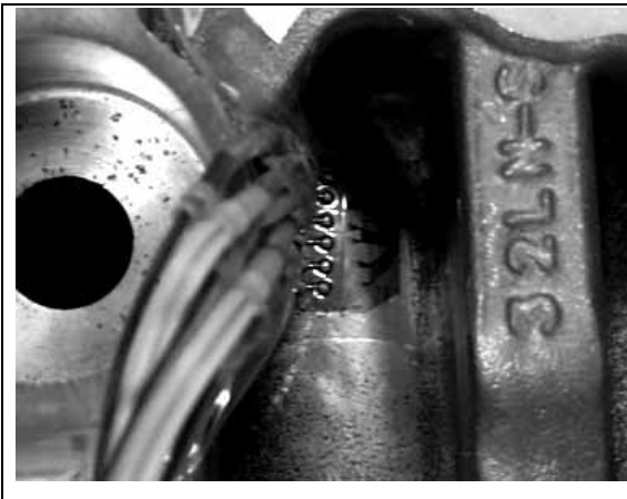
Şekil 13. Eğik düzleme yapıştırılmış gerilme ölçer
