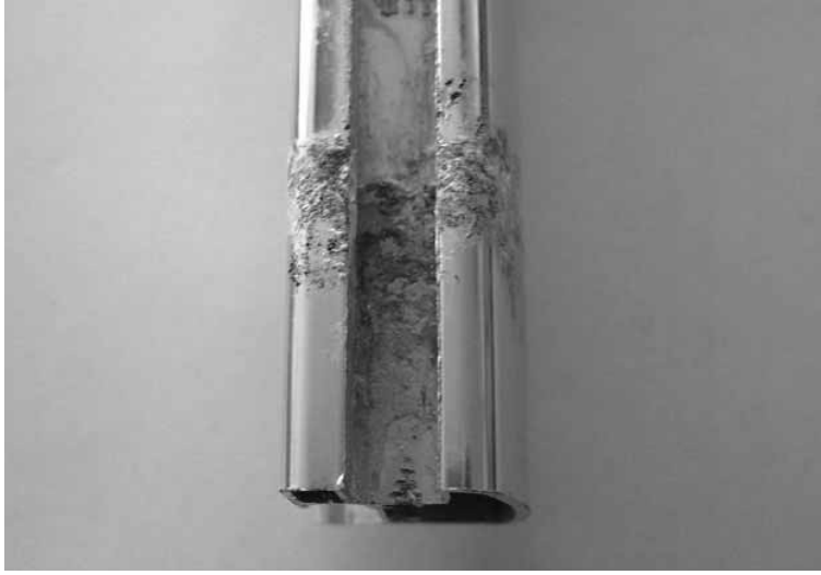
Şekil 1. Korozyon hasarlı profil örneğinin genel görünümü
