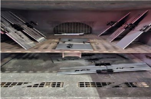
Şekil 4. Kürlenme fırını kupon görseli
