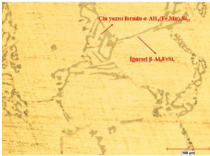
Şekil 12. Çin yazısı formülü \alpha - Al_{15}(Fe,Mn)_3Si_2 ve iğnesel \beta - Al_5FeSi metalleri arasındaki bileşiklerin 50X büyütmede optik mikroskop görüntüsü
