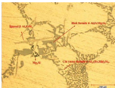
Şekil 13. Çin yazısı formülü \alpha - Al_{15}(Fe,Mn)_3Si_2 , iğnesel \beta - Al_5FeSi ve blok formülü \pi - Al_2FeMg_2Si_4 metalleri arasındaki bileşiklerin 50X büyütmede optik mikroskop görüntüsü
