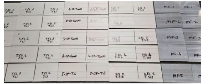
Şekil 1. Lap-Shear testi öncesi hazırlanmış alüminyum kuponlar
