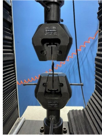
Şekil 3. Shimadzu çekme test cihazı.
