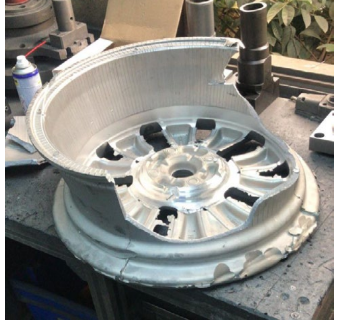
Şekil 2. Çapak Nedeniyle Tezgah Binmesi Yaşanan Jant
