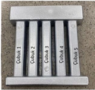
Şekil 4. Makroyapı ve mikroyapı numune dökümü
