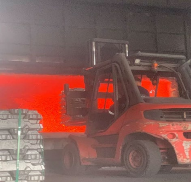
Şekil 1. Ergitme Fırınına Forklift ile Hammade Yükleme
