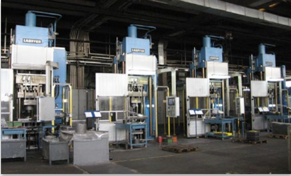
Şekil 5- Toz presleme sürecinde kullanılan 9 eksenli hidrolik presler
