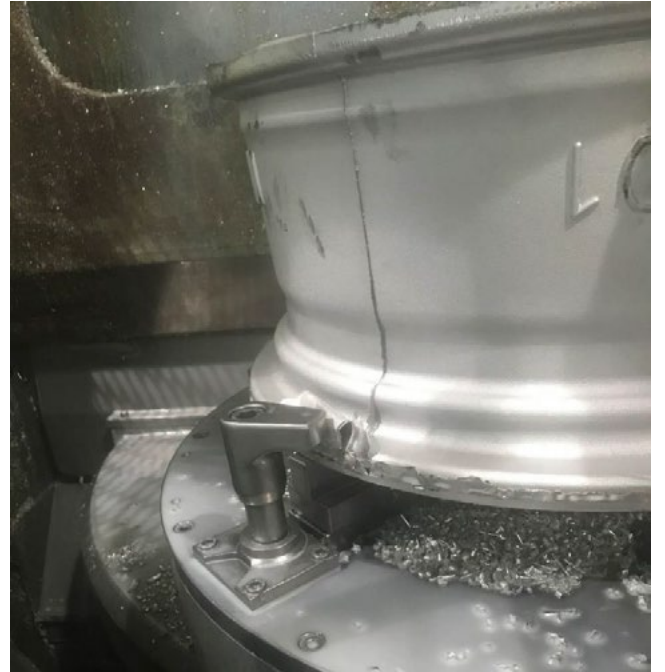
Şekil 3. Çapak ve Sıkma Ayaklarında Oluşan Hata
