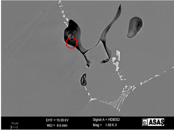
Şekil 3. Klor Kullanılmayan Sıvı Metal Numunesi Gaz Giderme Sonrası SEM Analizi (B)
