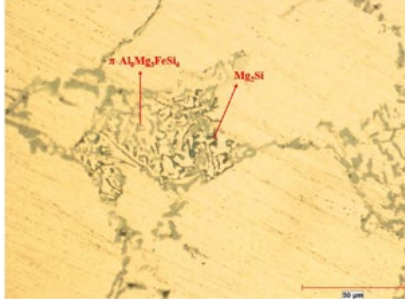
Şekil 11. \pi - Al_8Mg_3FeSi_6 ve Mg_2Si intermetaliklerinin 50X büyütmede optik mikroskop görüntüsü
