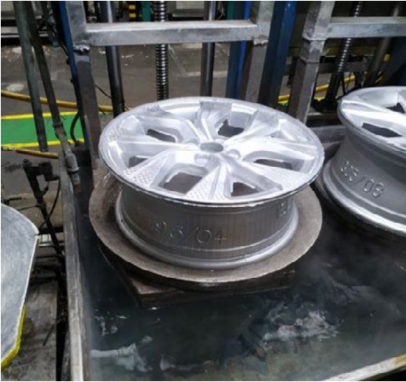
Şekil 9. Proje Kapsamında Deneme Dökümü Yapılan Jant
