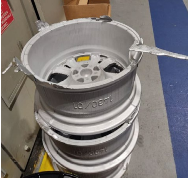
Şekil 1. Döküm Sonrası Jantta Meydana Gelen Çapak
