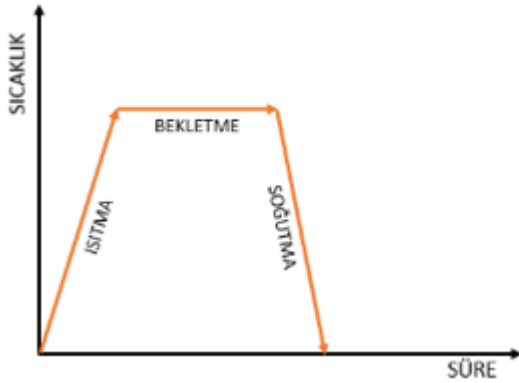
Şekil 1. Homojenizasyon ısıl işlemi adımları
