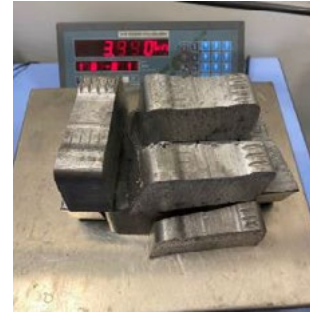
Şekil 1. 4 kg ( \pm 100 \text{ g} )'lık A356 Al alaşım külçeleri
