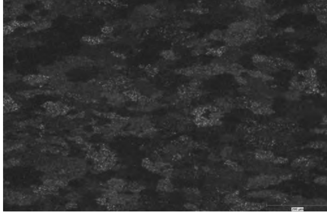
Şekil 16. 3. Proses 420°C 3 saat tavlama sonucu elde edilen makroyapı
