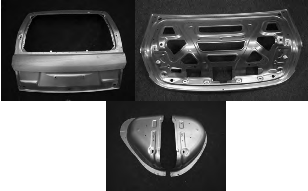
Şekil 4. Sürekli döküm tekniği ile üretilmiş 6016 alaşımından imal edilmiş parçalar.
