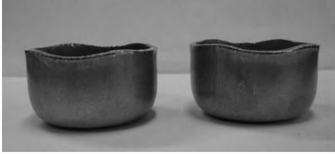
Şekil 13. 1. Prosese ait 270°C 3st nihai tavlı H0 malzemenin derin çekme testi sonrası kulaklanma görüntüsü
