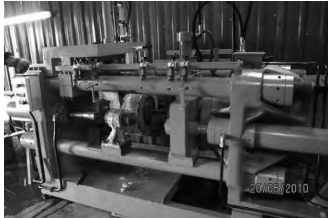
Şekil 2. Ar-Ge amaçlı ekstrüzyon presi.
