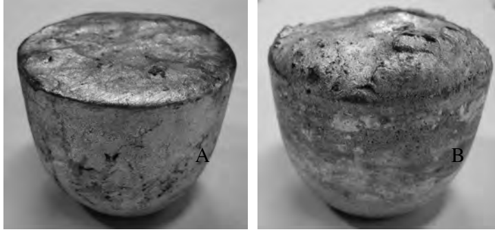
Şekil 7. Ergitme fırın içi alaşımlama ve rafinasyon öncesi alınan numunenin straubepfeiffer testi sonrası görüntüsü (A) Standart kullanılan hammadde, (B) yeni tedarikçiden alınan hammadde.
