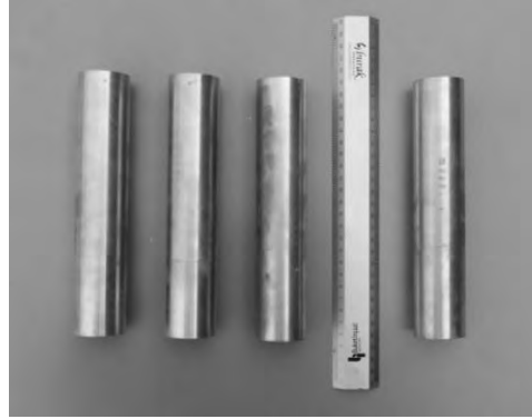
Şekil 1. 152 mm çaplı sürekli döküm biyetlerden 40 mm çap ve 200 mm boyda işlenmiş AA 7075 alaşımı takozlar.
