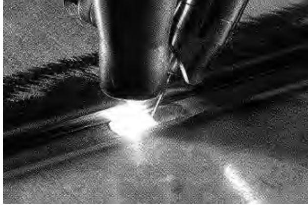
Şekil 8.- Kızgın tel ile plazma ark kaynağı uygulaması.
